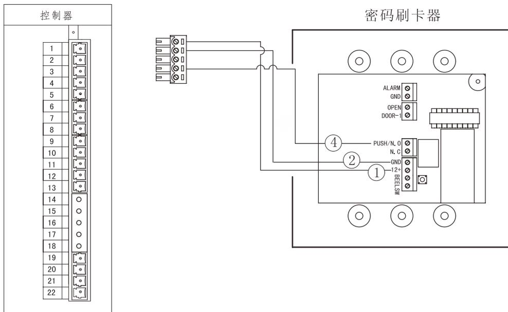
注意：如果门禁功率大于2.4W，需要从外界提供12V直流电源，切不可从自动门控制器系统取12V电源，负载过大时会导致控制器损坏。
