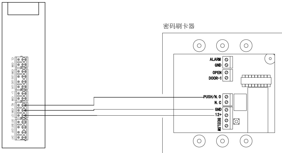
注意：如果密码刷卡器的信号输出为COM与NO，则COM与电源负极并联后接在磁悬浮接线板的COM端口，NO接在门禁信号端口
